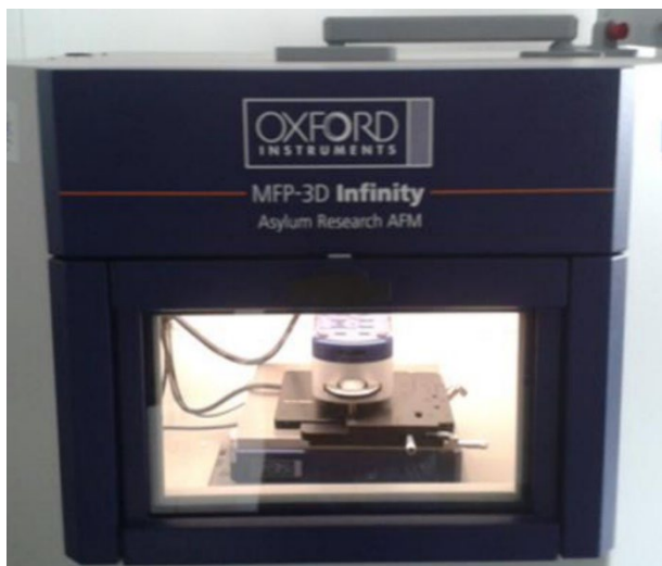
Obr. 1: Pohled na pracovní prostor AFM mikroskopu typu Oxford Instruments MFP-3D Infinity
