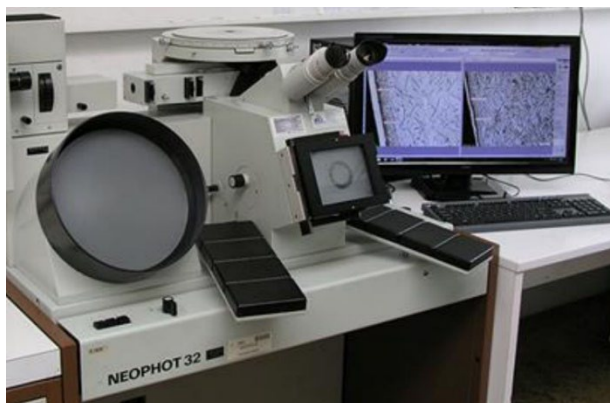
Obr. 2: Pohled na optický mikroskop Neophot 32 použitý v procesu mikrostrukturní analýzy základního materiálu zkoumané hlavňové oceli OCHN3MFA jakož i v procesu analýzy obrobených povrchů
