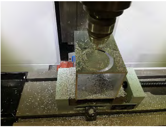
Obrázek 3: Průběh frézování kruhového otvoru pro motor
