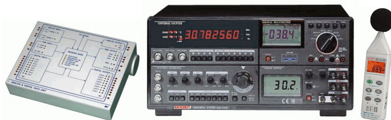
Obr.5 - Měřicí modul RC2000, měřicí stanice VoltCraft MS-9150 a digitální zvukoměr Lutron SL-4001
