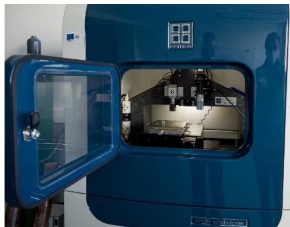
Obr. 1: Celkový pohled experimentální přístroj Hysitron TI 950 Triboindenter od společnosti Bruker.
